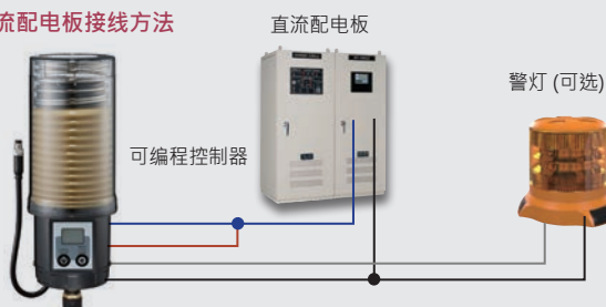
直流配电板接线方法
