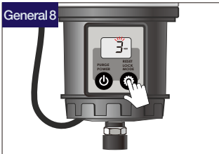
更改周期设置: 长按MODE键, 待挂锁图标消失后解锁, 再按MODE键循环设置
